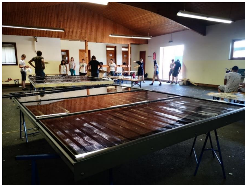
Dva skoraj dokončana sprejemnika, ki so ju zgradili učenci Nove srednje šole Heiligenkreuz (Avstrija)
