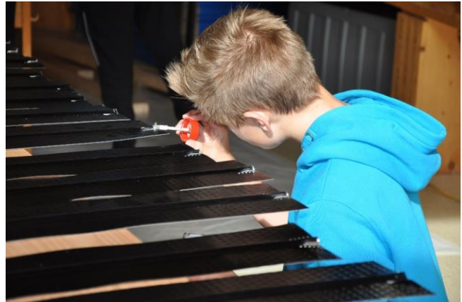
Εφαρμογή της κόλλας συγκόλλησης στους σωλήνες απορρόφησης
