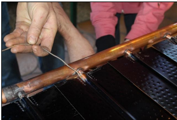
7. Σύνδεση και συγκόλληση των χάλκινων συλλεκτών στις ταινίες απορρόφησης
