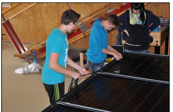
10. Namestitev kovinskih okvirjev za pritrditev stekla in vstavitev tesnila
